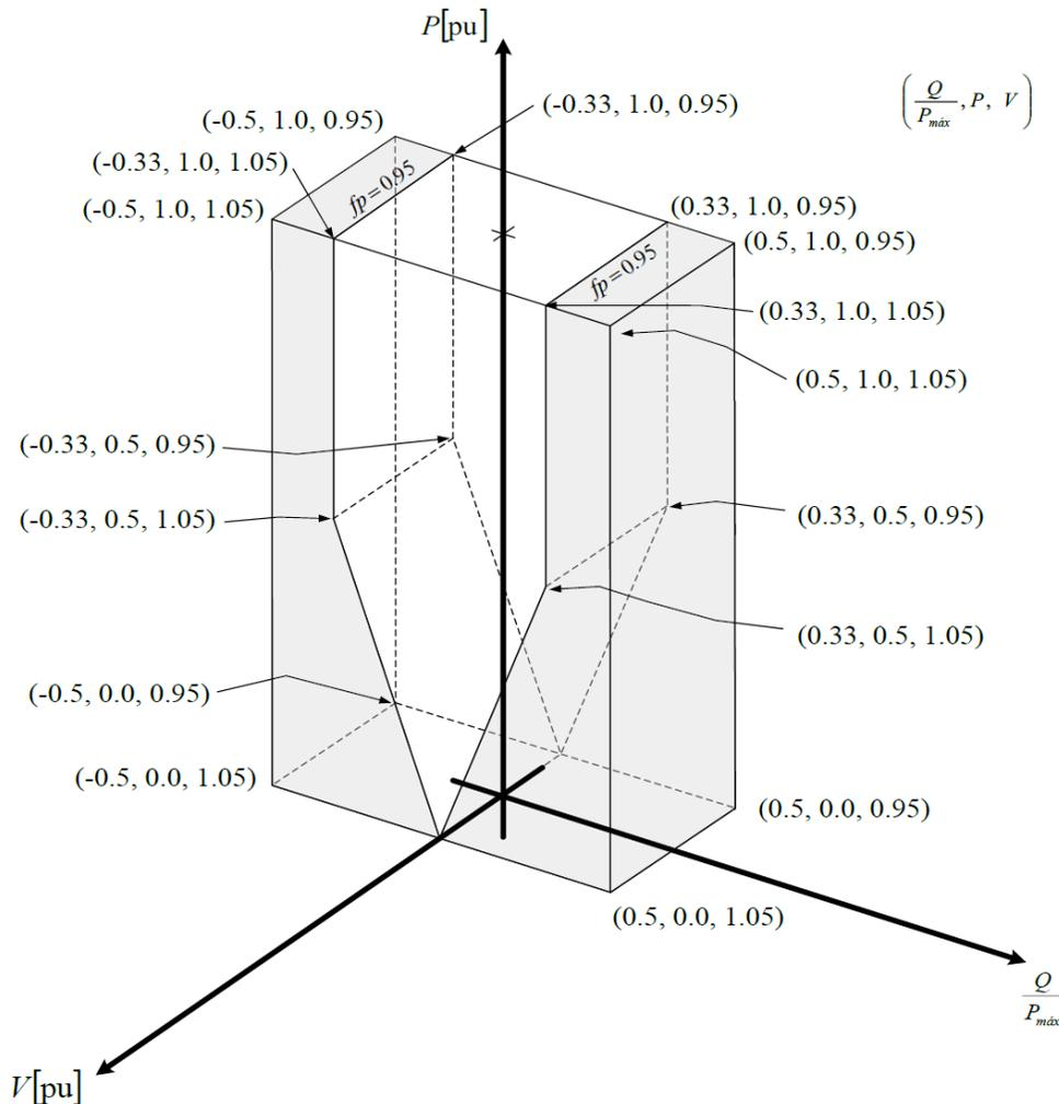
Figura 3.5.2: Diagrama V-P-Q/P<sub>máx</sub> de una Central Eléctrica Asíncrona tipo B, C o D.
