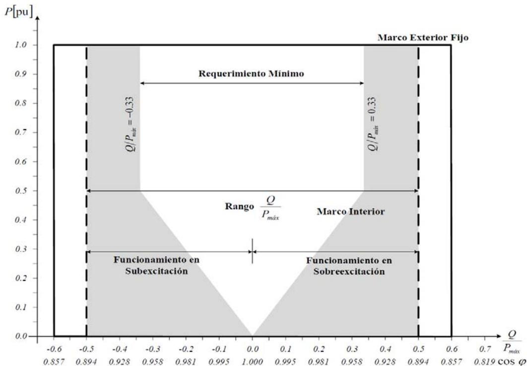
Figura 3.5.1: Diagrama P-Q/P<sub>máx</sub> de una Central Eléctrica Asíncrona tipo B, C o D.
