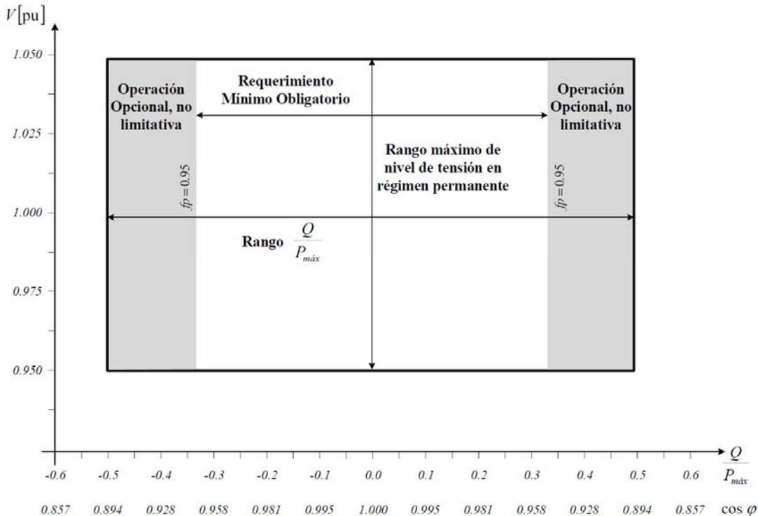
Figura 3.3.2 Diagrama V-Q/P<sub>máx</sub> de una Central Eléctrica Síncrona
